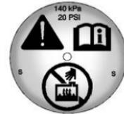
1. Retire el tapón de presión del tanque de compensación del refrigerante cuando el sistema de enfriamiento, incluyendo el tapón de presión del tanque de compensación del refrigerante y la manguera superior del radiador, ya no estén calientes.
