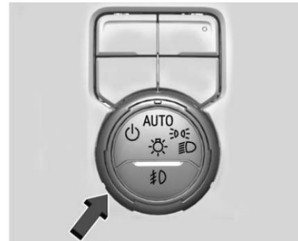
Los controles de luz exterior están en el tablero de instrumentos a la izquierda del volante.
