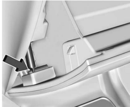
2. Empuje el brazo del amortiguador hacia la izquierda hasta que libere la guantera.
