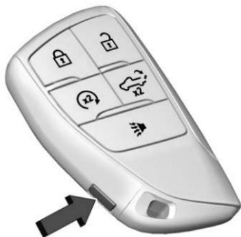
: El motor puede arrancarse desde el exterior del vehículo utilizando la llave remota. Presione dos veces. Consulte *Arranque remoto del vehículo* ⇨ 18.
