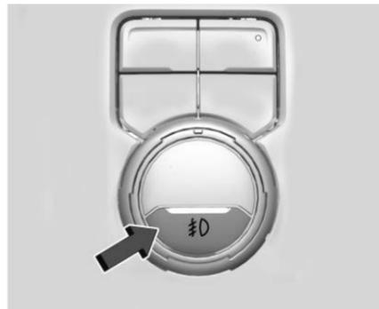
Si está equipado, el control de faro antiniebla está cerca del control de luz exterior a la izquierda de la columna de dirección.
