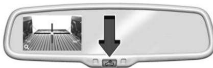
Cuando esté en modo de Acercamiento, la pantalla presenta guías para ayudar al conductor a alinear el vehículo cuando conecte un remolque. El conductor puede ajustar la posición de la guía horizontal y vertical.
