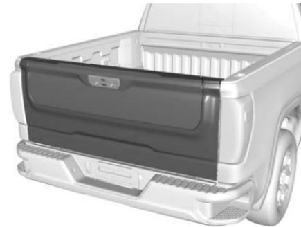
Los interruptores en la puerta trasera interna previenen que la puerta trasera principal se abra cuando la puerta trasera interna no está cerrada completamente.
