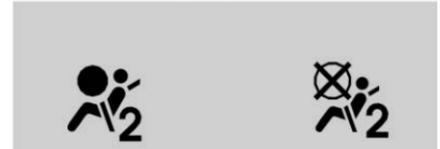
Los símbolos del indicador de estado de la bolsa de aire del pasajero se iluminarán por varios segundos como una verificación del sistema. Entonces, después de varios segundos más, el indicador de estado se iluminará para indicarle el estado de la bolsa de aire delantera del pasajero externo delantero. Vea *Indicador de estado de bolsa de aire del pasajero* ⇨ 112.
