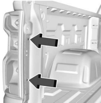
2. Retire los dos tornillos del ensamblaje de la luz trasera.
