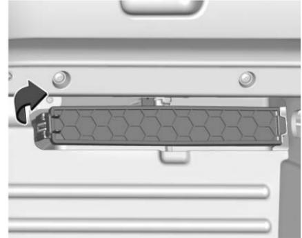
4. Jale la palanca en el lado izquierdo de la puerta de filtro y deslice a la izquierda, y después retire la puerta. Retire el filtro anterior.
