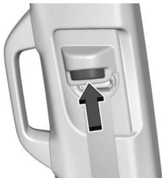
Presione el botón de liberación para mover el ajustador de altura a la posición deseada.
