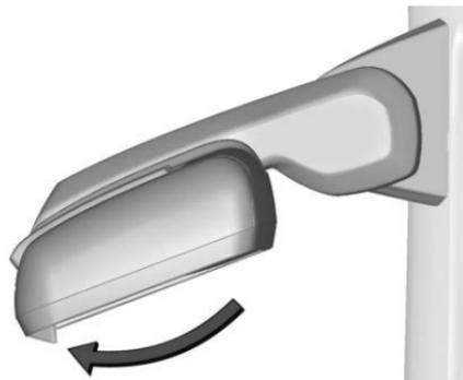
Si está equipado, sujete firmemente la carcasa del espejo y jale hacia atrás en un movimiento, arqueando ligeramente hacia la parte trasera del vehículo.
