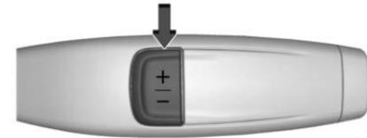
El Modo de selección de rango ayuda a controlar la transmisión del vehículo y la velocidad del vehículo mientras conduce cuesta abajo o transporta un remolque. Permite la selección manual de un rango de velocidad deseado.
