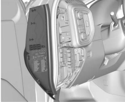
La puerta de acceso al bloque de fusibles del tablero de instrumentos izquierdo está en el borde del lado del conductor del tablero de instrumentos.
