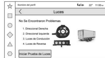
Esta vista muestra los nombres de las clavijas del conector del remolque, una gráfica del conector del remolque y una gráfica de la parte posterior del remolque.
