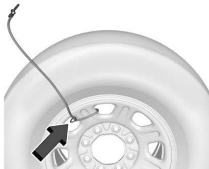
1. Si está equipado con un cable de llanta de refacción, vuelva a instalar el cable en la rueda de refacción enrollando el cable alrededor de la ventana de ventilación de la rueda y luego pase el extremo del broche del cable a través del extremo
