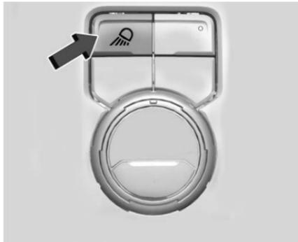
Si está equipado, la iluminación de tarea proyecta luz desde los espejos exteriores hacia afuera del vehículo.
