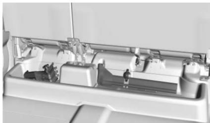
El equipo está debajo de los asientos de segunda fila, si está equipado, o detrás de los asientos de la fila delantera en modelos de cabina regular.
