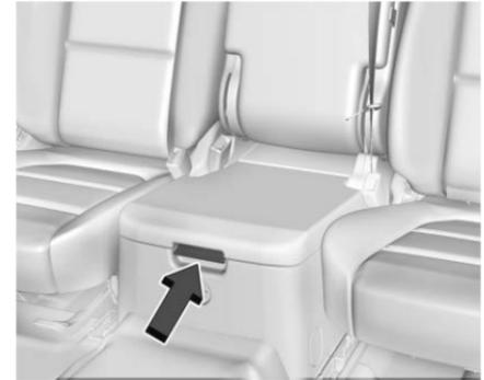
Si está equipado con almacenamiento del asiento central delantero, desbloquee con la llave mecánica de la llave remota, presione el seguro, y levante para abrir. Vea *Llaves* ⇨ 10.
