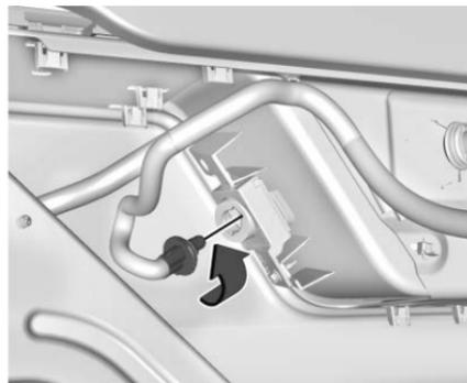
3. Reemplace el foco e invierta el Paso 2 para reinstalar.
